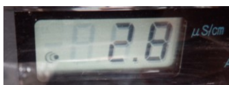
4/17日 自動運転稼働時 2.8 μS/cm ※交換が必要 純水装(イオン交換塔) 電気伝導率
