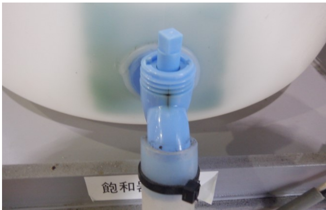
溶液タンクのコックヒビ(修理完了)
